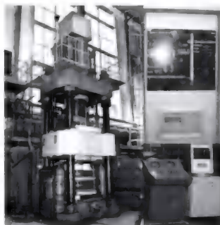
Рис. 1. Пресс для изотермической штамповки усилием 1600 тс с компьютерным управлением процессом деформации
